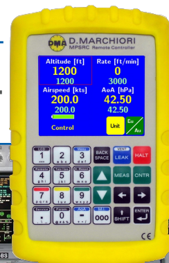
Volitelný ruční dálkový ovladač MPSRC: klávesnice a barevný dotykový displej velikosti 3,5" s podsvícením
